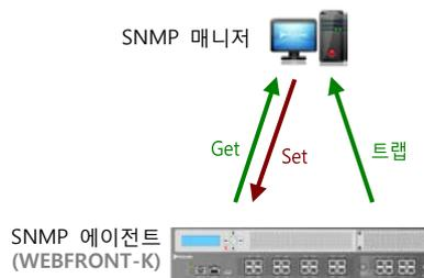
그림에서와 같이 SNMP 매니저가 SNMP 에이전트에서 MIB의 값을 읽어 갈 때에는 Get이라는 명령을 사용하고, MIB의 값을 변경할 때에는 Set 명령을 사용합니다.
